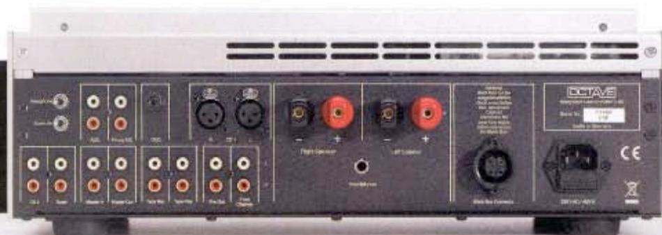
Mit vorzüglichem Phono MC, Prozessor- und Tape-Schleife sowie Pre-Outs bietet der V 80 alle Anschlussmöglichkeiten. Profi-ICs desymmetrieren an den XLR-Eingängen ankommende Signale.
