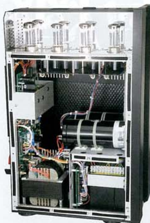
本機の内部。カスタムメイドのトランスが下部に搭載されている
